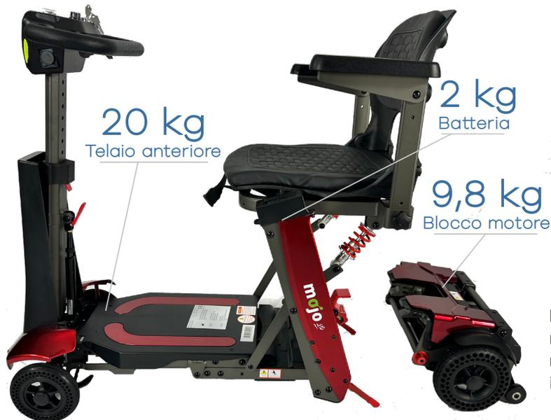
Dotato di sospensioni regolabili e blocco motore con ammortizzatori
