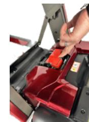
Leva di rilascio del blocco motore (27) (leva rossa).
