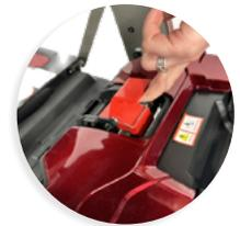
2 - Rimuovere il blocco motore con una mano. Con l'altra, rimuovere il telaio fino a quando le barre guida (rosse) toccano il pavimento.
